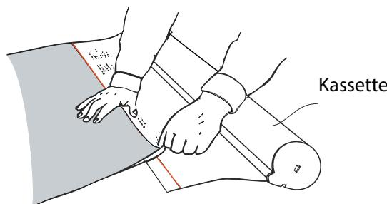
3. Schutzfolie abnehmen. Das untere Ende des Bannerdrucks (Druckbild nach oben) entlang der roten Linie positionieren und aufkleben.
