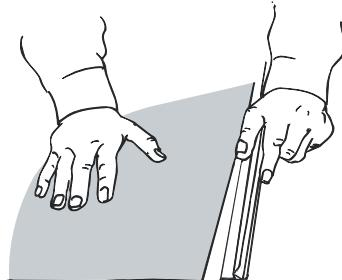
1. Öffnen Sie die Klemmleiste und setzen Sie das obere Ende des fertigen Bannerdrucks ein.
