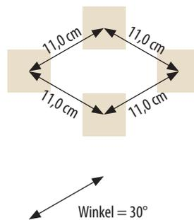
Der Druckbereich wird automatisch in Rautenform verteilt und auf der gesamten Fläche der Rolle platziert (siehe Abbildung).
