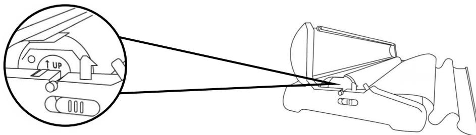
8. Die Rolle mit dem Bannerdruck in das Gehäuse setzen und den restlichen Bannerdruck außen liegen lassen.
