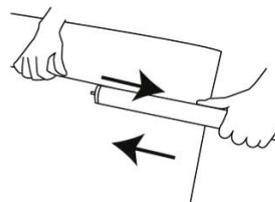
6. Gehäuse durch Drücken der Tasten auf den beiden Seiten öffnen und die innenliegende Rolle herausnehmen.
