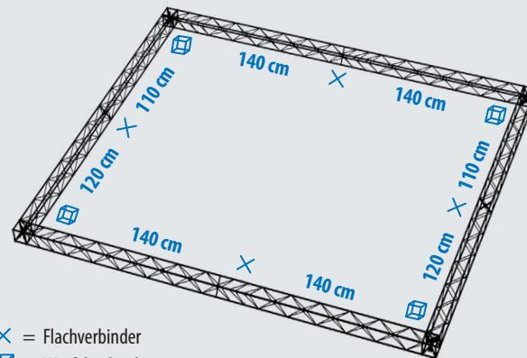
2. An der Unterseite der beiden unteren Würfelverbinder jeweils einen Standfuß (60 x 16 cm) befestigen.
