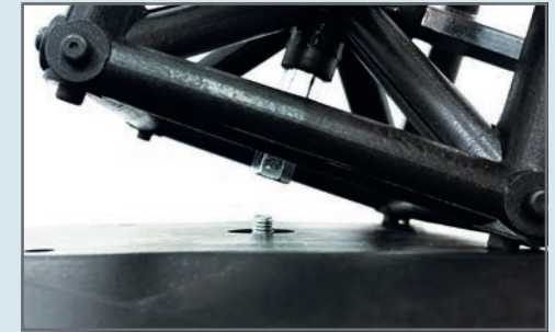
Sterngriffschraube von unten am Würfelverbinder festdrehen.
