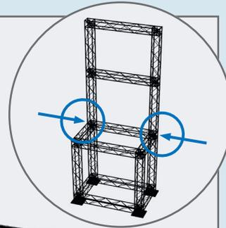
4. Nun aus 4 Traversenmodulen (1 x 90 cm, 1 x 100 cm, 1 x 110 cm und 1 x 120 cm) sowie 2 Flach- und 2 Würfelverbindern die Rückwand des L-Stands zusammenschrauben. Danach am Würfelverbinder in der Ecke einen Standfuß (16 x 16 cm) an der Unterseite anbringen. Anschließend die Rückwand mit dem Messetisch verbinden (siehe Kreis).
