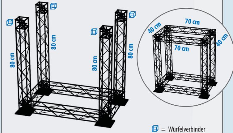
3. Mit 4 Traversenmodulen (Länge 70 cm), 2 Traversenmodulen (Länge 60 cm), und 4 Würfelverbindern zunächst die Rückwand des Messetischs zusammenbauen. Im zweiten Schritt die Rückwand auf das Tischgerüst montieren.
