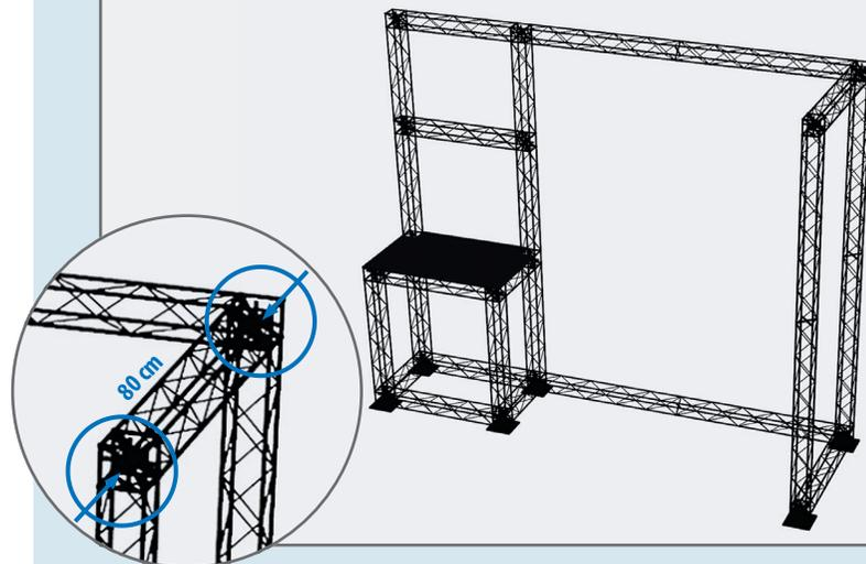
6. Aus 3 Traversenmodulen (1 x 80 cm, 1 x 110 cm und 1 x 120 cm) sowie einem Flach- und zwei Würfelverbindern die Seitenwand des L-Stands zusammenschrauben. Danach am Würfelverbinder in der Ecke den letzten Standfuß (16 x 16 cm) an der Unterseite anbringen. Zum Schluss die Seitenwand mit der Rückwand wie unten abgebildet verbinden.
