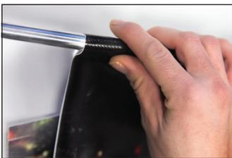
3. Ziehen Sie anschließend den Druck über die Aluminium Rundstange und fixieren Sie ihn mit der Schraube.
