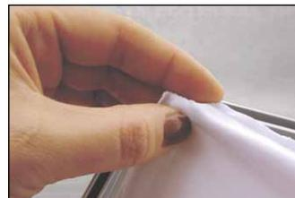
4. Die Gummileiste des Spannrahmendrucks um 90° nach hinten umschlagen. Die Gummileiste wird somit verdeckt und kann in den Spannrahmen eingedrückt werden.
