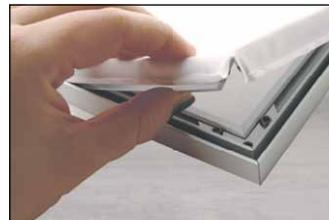
5. Die gleiche Verfahrensweise an den weiteren Ecken vornehmen. Bitte beachten Sie, dass das Material an den Ecken sauber eingeschlagen wird.
