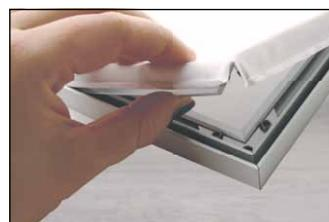
8. Die gleiche Verfahrensweise an den weiteren Ecken vornehmen. Bitte beachten Sie, dass das Material an den Ecken sauber eingeschlagen wird.
