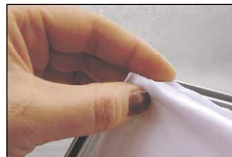
7. Die Gummileiste des Spannrahmendrucks um 90° nach hinten umschlagen. Die Gummileiste wird somit verdeckt und kann in den Spannrahmen eingedrückt werden.
