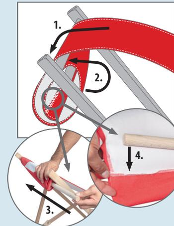
3. Fädeln Sie den neuen Bezug durch die Haltevorrichtung. Platzieren Sie die beiden Stäbe im oberen und unteren Saum, um den Bezug zu fixieren.
