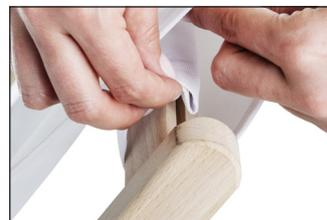
1. Lösen Sie die Holzleisten aus der Nut oben und unten.
