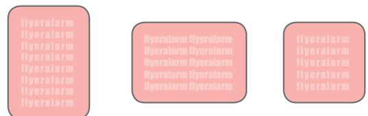
Bei der Ausführung **mit abgerundeten Ecken** beträgt der Eckenradius 3 mm.
