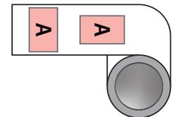
Die Ausrichtung des Formats muss der gewünschten Variante entsprechend angeliefert werden.
